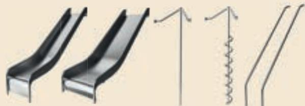
POZNÁMKA: Ocelové skluzavky zahřívané poledním sluncem mohou způsobit popáleniny kůže. Doporučujeme nasměrování mimo polední slunce, skluzavky z PE nebo stínění.
